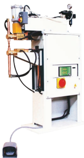
Машины 35-80 кВА (линейное перемещение плеча)
