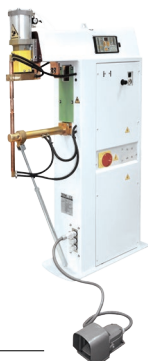
Машины 35-50 кВА (радиальное, линейное перемещение плеча)
