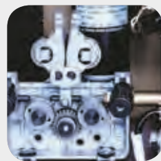
4-роликовое устройство подачи проволоки с мощным мотором.
